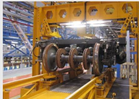
Druck- / Prüfstände für Drehgestelle
